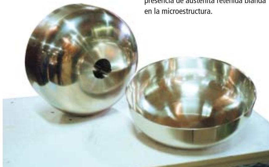
*Utillaje para embutición profunda de ensaladeras de acero inoxidable. El material utilizado en el utillaje es Sverker 21.*
