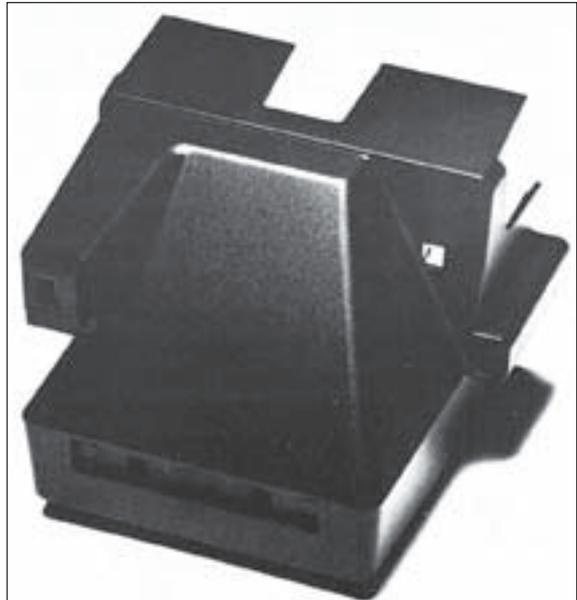
*Cuerpo de una cámara fotográfica instantánea Polaroid, con textura fotograbada en el molde. Material del molde: STAVAX ESR.*
