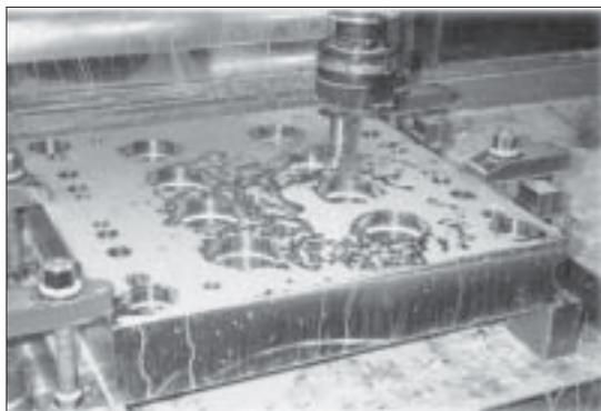
*La aptitud de mecanizado es una propiedad crítica durante la fabricación de placas soporte.*
