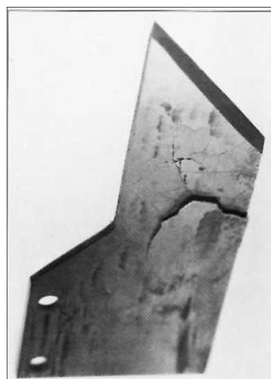
Foto 2: Grietas de rectificado.
