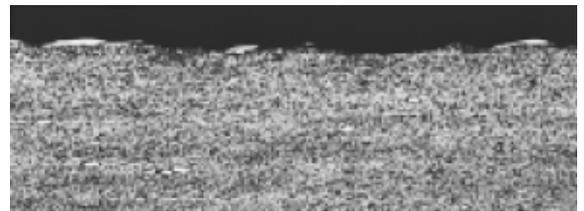
Fig. 5. RIGOR después de ser sometido a mecanizado de acabado. Duración de los pulsos 10 μs.
